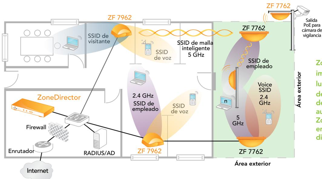
**ZoneDirector se puede implementar en cualquier lugar dentro de una red de 2/3 capas. Todos los PA de ZoneFlex encuentran automáticamente a ZoneDirector y se ponen en funcionamiento dinámicamente.**
